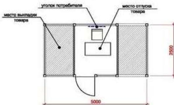
Каркас павильона выполнить из металлической трубы и окрасить в соответствии с проектным решением. Фасад выполнить из арматурной сетки. Тент выполнить из ткани с водостойким покрытием.
